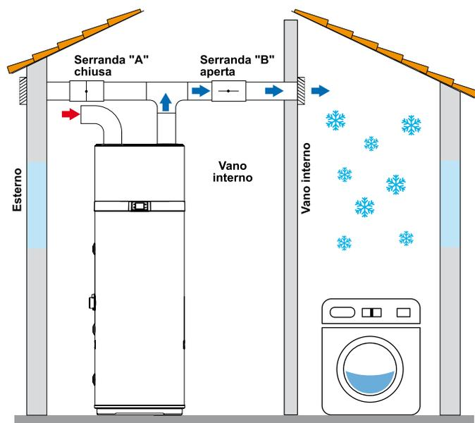
Fig. 3 - Esempio di installazione nel periodo estivo
