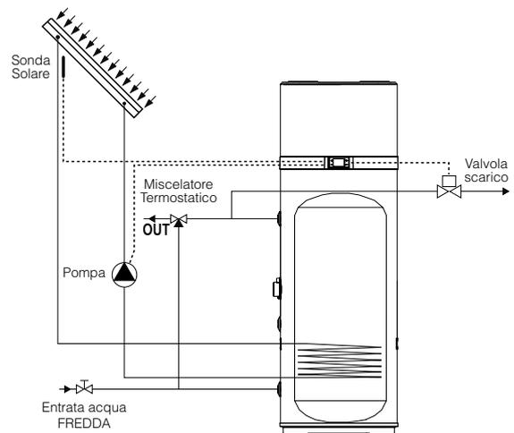
**EGEA** gestisce direttamente con la **propria** elettronica tutti i componenti del Circuito Solare ottimizzando il funzionamento della pompa di calore alla disponibilità di Energia Solare.
