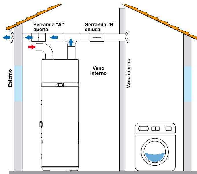
Fig. 4 - Esempio di installazione nel periodo invernale
